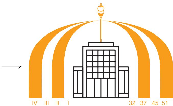
El nivel de protección se determina con la norma NFC 17-102 ed. 2011, o EN 62305-2, o con el guía FDC 17-108. Si existe un riesgo para el medio ambiente, el radio de protección debe ser reducido de un 40%. Para un nivel de protección I++ (Ver 5.2.3.5 NFC 17-102), el radio de protección debe también ser reducido de un 40%.
